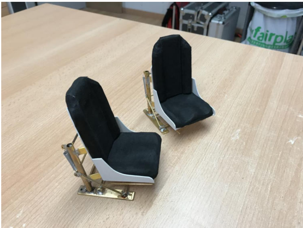
Die Sitze entstanden aus Messing, ABS Platten und etwas hartem Schaumstoff.
